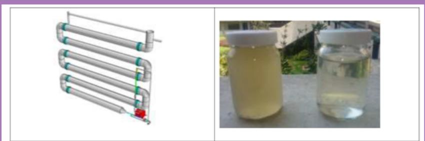
Figura 1 Sistema tubular, agua cruda y tratada
