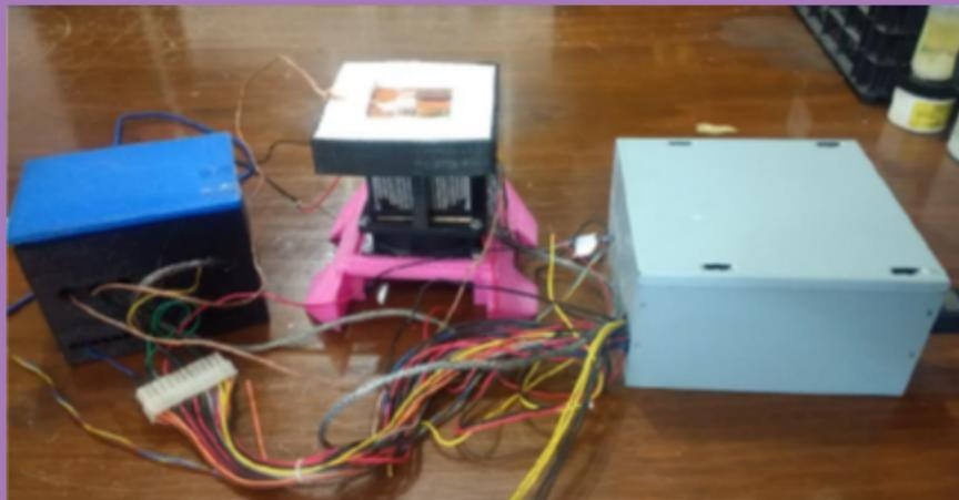
Figura. Componentes del Sistema para demostrar el flujo de calor en sistemas constructivos de edificaciones en casos dependientes del tiempo
